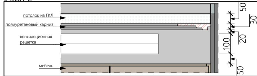
короб из ГКЛ на отм. 2.650 опуск 300мм.
