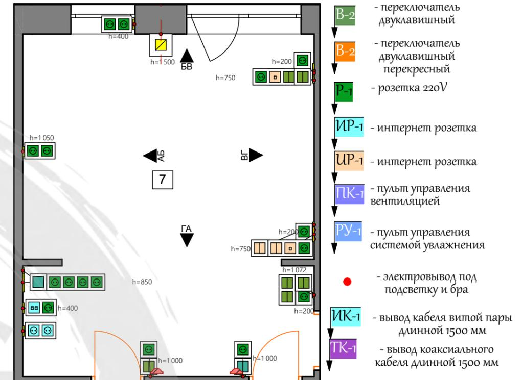
1. Все размеры и привязки являются проектными и требуют дополнительного уточнения после монтажа перегородок и отделочных работ.
