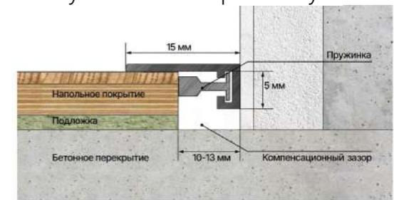
Схема установки микроплинтуса
